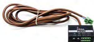
Cavetto antifiamma 2x1 mm. In un capo è collegato una morsettiera due poli pronta per il collegamento ad innesto rapido alle uscite di potenza delle centraline "PROLED" e "PROLED/D". Sul capo opposto una presa multipla a 4 uscite: 2 uscite a morsettiera, 2 uscite prese DC Ø 2,5 mm.
